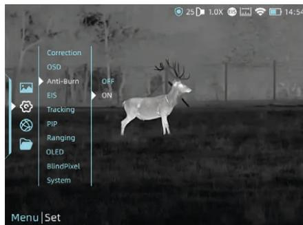
Funzione anti-bruciatura del rilevatore, può essere impostata tramite on/off.
